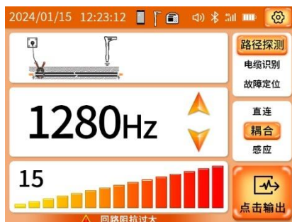
图 19 管线探测模式卡钳耦合输出界面
