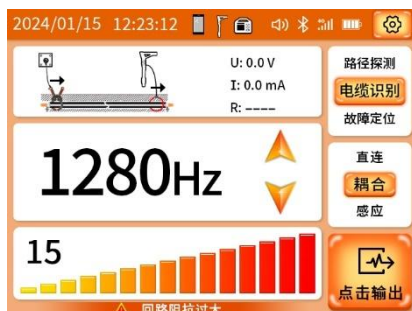
图 20 电缆识别模式卡钳耦合输出界面
