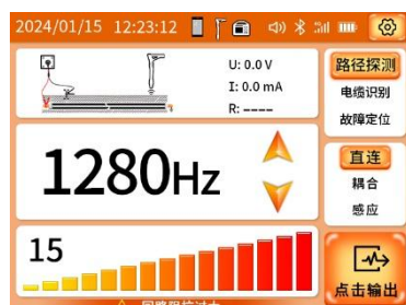
图 6 路径探测信号发射界面图
